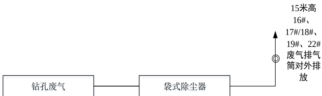
图 4-3 钻孔废气处理及排放流程（附“◎”废气监测点位）
